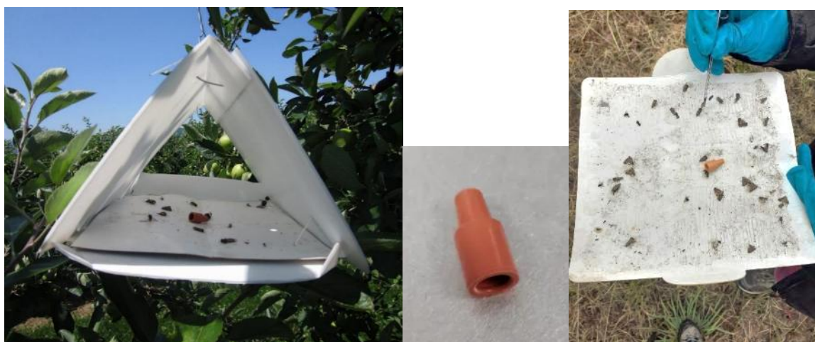
Piège Delta contenant une plaque engluée et une capsule de phéromone spécifique à l'insecte à suivre.
