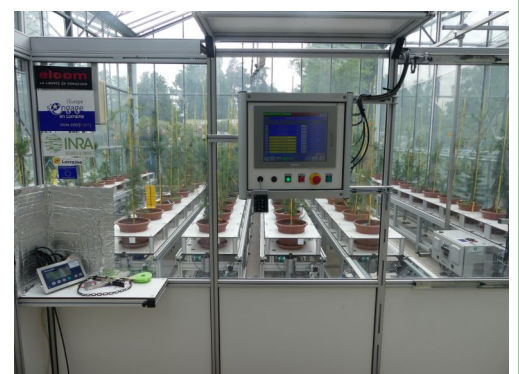
Serre dédiée aux expérimentations, avec gestion automatisée (conditions climatiques, déplacement robotisé des pots...)
